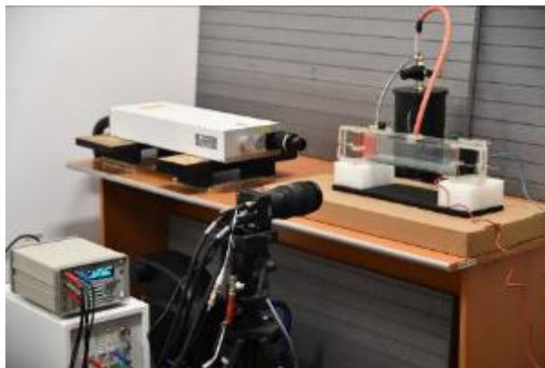
Fig. 45. Testarea sistemului PIV pe un stand transparent
