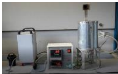
Fig. 23. - Stand pentru determinarea temperaturii de autoaprindere a lichidelor inflamabile conform SR EN 14522/2006
