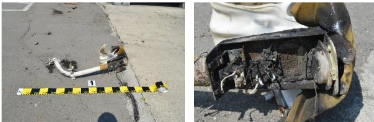
Fig. 16. Exemplu de probă: Lampă iluminat de tip stradal, prezentând puternice urme de afectare termică (dreapta, foto detaliu)
