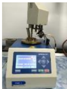
Fig. 22. Aparat automat pentru determinarea punctului de inflamabilitate Pensky -Martens
