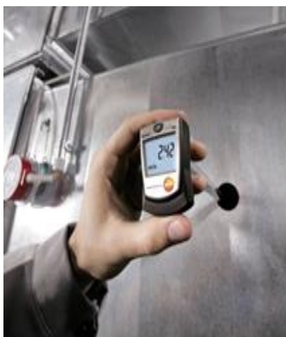
Anemometru cu fir cald - testo 405 cu mâner telescopic extensibil până la 30 cm
