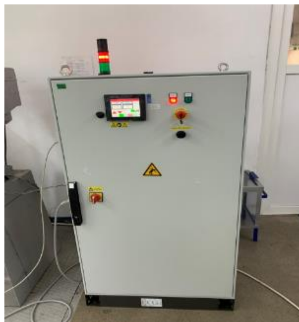
Fig. 5. Sursă de tensiune reglabilă și programabilă
