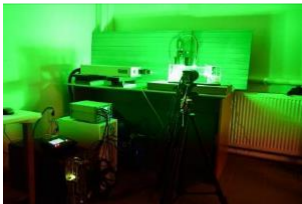
Fig. 7. Testarea sistemului PIV pe un stand transparent
