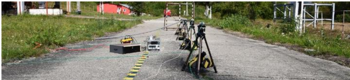
Montajul în linie a senzorilor de presiune cu senzorul TESTES de gaz
