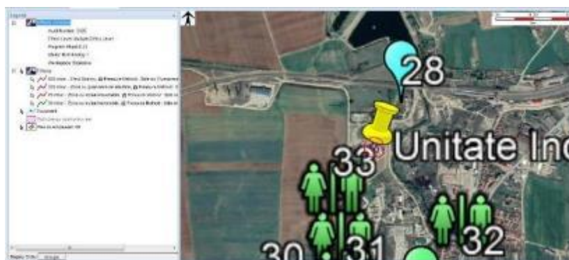
Fig. 52. Contur suprapresiuni de explozie (30, 70, 300, 600 mbar)
