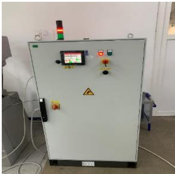
Fig. 31. Sursă de tensiune reglabilă și programabilă
